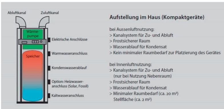
Wärmepumpenboiler eignen sich für den Einsatz in Ein- und Zweifamilienhäusern. Sie nutzen Wärme aus der Umgebungsluft und erzeugen Warmwasser bis 60°C. Mit einem zusätzlich eingebauten Elektroeinbauelement können auch höhere Komforttemperaturen bereitgestellt werden.
